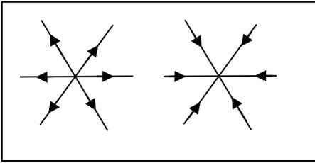
Можно заметить, что в случае *стока* или *источника* поля, при стягивании поверхности  $S$  в точку, векторное поле становится похожим на картину силовых точечных зарядов.
