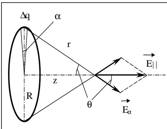
участком:  $E_\alpha = k \frac{q}{r^2}$ , где  $r = \sqrt{R^2 + z^2}$  - расстояние от заряда до рассматриваемой точки. При этом участок, расположенный симметрично относительно центра кольца, создает вектор напряженности, симметричный уже найденному. Их сумма будет лежать на оси кольца (вектор  $\vec{E}_||$ ). Поэтому при суммировании всех векторов напряженностей от каждого из участков будем учитывать только
