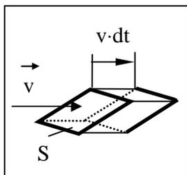
**Пример.** Найдем объем жидкости протекающей через некоторую малую наклонную площадку за единицу времени.
