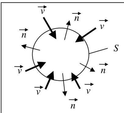
Предположим, что векторное поле «втекает» внутрь объёма  $V$ , т.е. в каждой точке поверхности  $S$  векторы  $\vec{v}$  направлены против векторов нормалей  $\vec{n}$ . Поэтому в каждой точке скалярное произведение  $(\vec{v}, d\vec{S}) = (\vec{v}, \vec{n}) dS < 0$  отрицательно.
