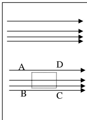
**Пример.** Можно ли создать неоднородное электростатическое поле, силовые линии которого параллельны друг другу?
