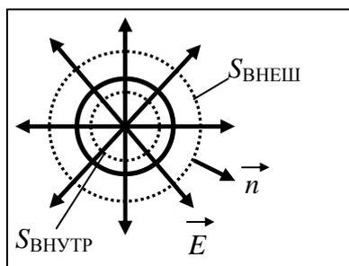
б) Поле, создаваемое шаром радиуса  $R$  и заряженным равномерно зарядом  $q$ . Картина силовых линий обладает центральной симметрией. Выделим внутри шара сферу радиуса  $r$  с центром, совпадающим с центром шара. Тогда
