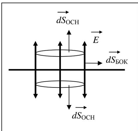
3) *Поле бесконечной заряженной плоскости.* Пусть поверхностная плотность заряда  $\sigma > 0$ . Картина силовых линий симметрична относительно плоскости. Найдем поток через поверхность прямого цилиндра, основания которого параллельны плоскости, и расположенного так, что плоскость делит цилиндр *пополам*. В этом случае наблюдается симметрия относительно плоскости.
