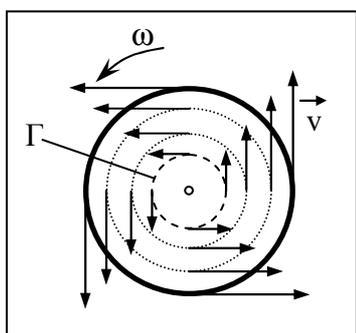
Длина этой окружности  $2\pi R$ , она охватывает площадку  $S$ , площадь которой  $\pi R^2$ . В каждой точке этой окружности вектор скорости направлен по касательной к ней, поэтому угол между малым касательным вектором  $d\vec{l}$  и вектором скорости  $\vec{v}$  равен нулю. Следовательно  $(\vec{v}, d\vec{l}) = v \cdot dl$ .
