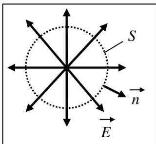
Пусть  $q > 0$ . Возьмём в качестве поверхности  $S$  сферу радиусом  $R$  с центром в месте нахождения заряда. На поверхности этой сферы вектор  $\vec{E}$  сонаправлен с вектором внешней нормали  $\vec{n}$  к поверхности сферы, поэтому  $(\vec{E}, d\vec{S}) = (\vec{E}, \vec{n}) dS = E |\vec{n}| \cos 0^\circ dS = E dS$ . В каждой точке поверхности сферы, поэтому
