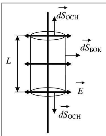
2) *Поле бесконечной прямой заряженной нити.* Пусть нить заряжена с линейной плотностью заряда  $\lambda > 0$ .
