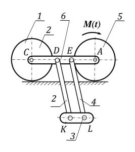
**16.** Два однородных круглых цилиндра 1 и 5 катаются без скольжения по горизонтальной плоскости. Масса каждого цилиндра  $m_1$ , а радиус R. К цилиндру 5 приложена пара сил с моментом M(t). К раме 6, соединявшей оси цилиндров, шарнирно прикреплены однородные стержни 2 и 4 массы  $m_2$  и длины l каждый. Концы этих стержней соединены спарником 3 массы  $m_3$ , причем KL = DE.
