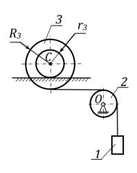
**2.** Груз 1 массой  $m_1$  прикреплён к нити, которая перекинута через блок 2 массой  $m_2$ , и другой ее конец охватывает внешнюю ступень катка 3 массой  $m_3$ . Каток 3 движется по горизонтальному рельсу с проскальзыванием.
