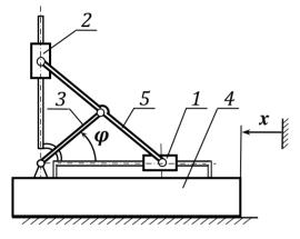
**29.** Механизм эллипсографа, находящийся в вертикальной плоскости, установлен на подставке 4, которая перемещается по гладкой горизонтальной плоскости. Массы ползунов 1 и 2 равны  $m_1 = m_2$ , масса подставки 4 -  $m_4$ , кривошип 3 - однородный стержень длиной l и массой  $m_3$ , длина линейки 5 равна 2l.
