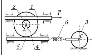
**14.** Зубчатая рейка 1 массой  $m_1$  скользит под действием силы  $\overline{F}$  в горизонтальных направляющих и приводит во вращение вокруг неподвижной оси, проходящей через точку О перпендикулярно плоскости рисунка, шестерню 2 радиусом r. С шестерней 2 жёстко соединена шестерня 4 радиусом R. Масса блока шестерён  $m_2$ , а его радиус инерции  $\rho$ . Шестерня 4 приводит в движение зубчатую рейку 5. К этой рейке прикреплен левый конец пружины 6.
