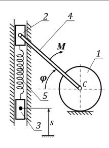
**19.** Однородный диск 1 массой  $m_l$  и радиусом R катается без скольжения по горизонтальной плоскости. К центру диска шарнирно прикреплен одним своим концом стержень 4 длиной l. К стержню приложена пара сил с моментом M(t). Другой конец стержня шарнирно прикреплён к ползуну 2 массой  $m_2$ , движущемуся в вертикальных направляющих. К ползуну 2 с помощью пружины 5, коэффициент жёсткости которой равен c, подвешен груз 3 массой  $m_3$ .
