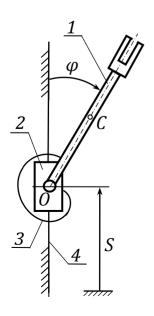
**12.** Исполнительный механизм робота расположен в вертикальной плоскости и состоит из штанги 1, ползуна 2 и спиральной пружины 3. Штанга 1 вращается вокруг оси, установленной в точке O ползуна 2 и перпендикулярной плоскости чертежа. Ползун 2 перемещается вдоль вертикальной направляющей 4. Концы спиральной пружины закреплены на штанге и ползуне. Развиваемый спиральной пружиной упругий момент  $M_{ynp} = c\varphi$ .
