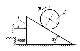
**26.** По горизонтальной плоскости двинется призма массой  $m_1$ . К призме прикреплён один конец горизонтальной пружины 3, коэффициент жесткости которой равен c. Второй конец этой пружины прикреплен к стене. По наклонной грани призмы, образующей угол  $\alpha = 60^\circ$  с горизонтом, катится без скольжения однородный круглый цилиндр 2 массой  $m_2$ .
