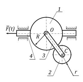
5. К 4. движущейся рейке поступательно горизонтальных направляющих, жестко прикреплена шестерня 1 радиусом R. Общая масса шестерни 1 и рейки равна  $m_1$ . К центру шестерни 1 шарнирно прикреплено водило 3, которое несёт ось шестерни 2 массой  $m_2$ . Шестерня 2 находится в зацеплении с шестерней 1. Механизм находится в вертикальной плоскости. К рейке приложена горизонтальная сила F(t).
