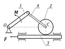
**9.** Кривошип 1 - однородный стержень массой  $m_1$ , вращаясь вокруг горизонтальной оси, проходящей через точку О перпендикулярно плоскости рисунка, приводит в движение шатун 4 и шарнирно связанную с ним шестерню 2 массой  $m_2$ . Шестерня 2 находится в зацеплении с рейкой 3 массой  $m_3$ , которая скользит в горизонтальных направляющих. К рейке приложена горизонтальная сила  $\overline{F}$ , а к кривошипу 1 - пара сил с моментом M. Шатун 4 имеет одинаковую с кривошипом длину l.
