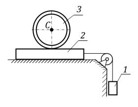
**33.** Груз 1 массы  $m_1$  посредством троса, перекинутого через невесомый блок, приводит в движение плиту 2 массой  $m_2$ , лежащую на гладкой горизонтальной поверхности. На плите расположен тонкостенный цилиндр 3 массой  $m_3$  и радиуса r, который может катиться без проскальзывания по поверхности плиты. Коэффициент трения качения равен  $\delta$ . Применив общее уравнение динамики, определить ускорение оси C цилиндра.
