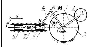
17. Коленчатый прямоугольный рычаг 1 массой  $m_I$ , вращается вокруг неподвижной горизонтальной оси в вертикальной плоскости. Правый конец рычага шарнирно связан с шестерней 2 массой  $m_2$  и радиусом r, находящейся в зацеплении с неподвижной шестерней 3. Левый конец рычага с помощью стержня 4 соединен с ползуном 5. Ползун 5 массой  $m_5$  связан с ползуном 6 массой  $m_6$  посредством пружины 7, коэффициент жесткости которой
