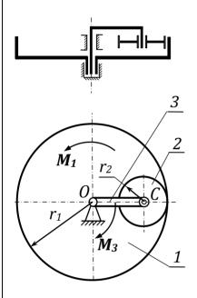
**8.** В дифференциальном механизме шестерня 1 массой  $m_1$  и радиусом  $r_1$  находится в зацеплении с подвижной шестерней 2 радиусом  $r_2$ , ось которой закреплена на конце водила 3. Оси вращения шестерни 1, водила 3 и шестерни 2 вертикальны. К шестерне 1 и водилу 3 приложены пары сил с моментами  $M_1$  и  $M_3$  соответственно, а к шестерне 2 - пара сил трения, момент которой равен  $M_2$ .
