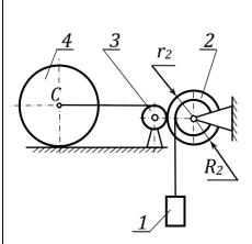
**3.** Груз 1 массой  $m_1$  прикреплен к тросу, охватывающему ступицу барабана 2 массой  $m_2$ , который находится в зацеплении с шестерней 3 массой  $m_3$ . Шестерня 3 жёстко связана с блоком, на который намотан трос. Другой конец троса прикреплен к оси катка 4 массой  $m_4$ . Каток 4 движется по горизонтальному рельсу с проскальзыванием. Внутренний радиус барабана  $r_2$ , внешний радиус  $R_2$ , радиус инерции барабана 2 относительно его оси  $\rho_2$ .
