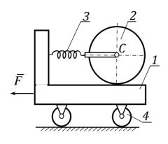
Четырехколесная **13.** тележка движется поступательно прямолинейно ПО шероховатой горизонтальной плоскости. Масса кузова тележки  $m_1$ , Ha шероховатой масса каждого колеса  $m_4$ . горизонтальной платформе тележки находится сплошной однородный цилиндрический каток 2 массой  $m_2$  и радиусом R. Центр катка 2 соединён с кузовом тележки горизонтальной пружиной 3, коэффициент жёсткости которой равен с. Колеса тележки, а также каток 2 могут катиться по своим опорным плоскостям без скольжения.
