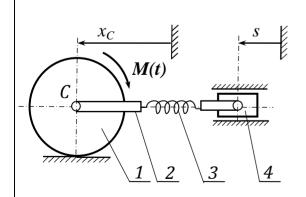
**15.** Однородный каток 1 массой  $m_1$  и радиусом r, движется по горизонтальному рельсу без проскальзывания под действием пары сил с моментом M(t). Ось катка через тягу 2 и пружину 3 связана со штоком 4. Коэффициент жёсткости пружины c.
