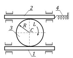
**18.** Рейки 1 и 2 массой  $m_1$  и  $m_2$  движутся в параллельных горизонтальных направляющих. Рейки находятся в зубчатом зацеплении с однородным диском 3 массой  $m_3$  и радиусом R. Рейка соединена пружиной 4 с неподвижной опорой. Ось пружины параллельна рейкам, коэффициент жёсткости пружины c. К диску приложена пара сил с моментом L. Составить дифференциальные уравнения движения системы. В начальный момент времени пружина не деформирована.
