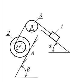
**1.** Груз 1 массой  $m_1$  скользит по наклонной плоскости, образующей угол  $\alpha$  с горизонтом. К грузу прикреплен конец нерастяжимой нити, которая переброшена через блок 3 и намотана на внутреннюю ступень катка 2 радиуса r, внешняя ступень которого имеет радиус R. Каток 2 катится со скольжением по плоскости, наклоненной к горизонту под углом  $\beta$ . Масса катка равна  $m_2$ , его радиус инерции  $\rho$ , коэффициент трения скольжения между катком и наклонной плоскостью равен f.
